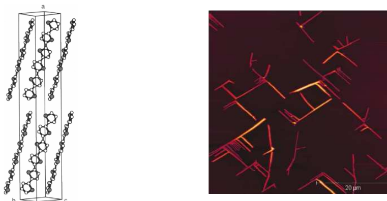
Fig. 2.17. (sinistra) Cella unitaria dell'esatofene. (destra) Cristalli di esatofene cresciuti su mica a 120°C per 60 minuti.
