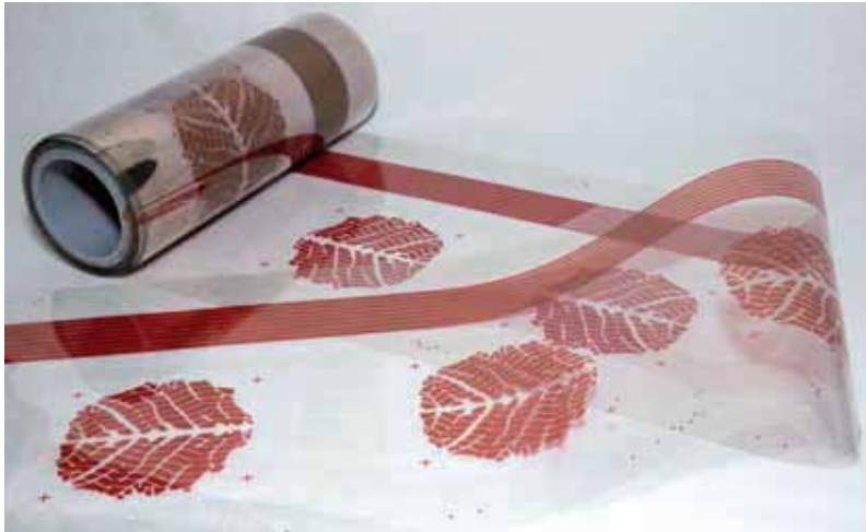
الشكل ١٠, ١١ "ورقة الشجر" العضوية الكهروضوئية
